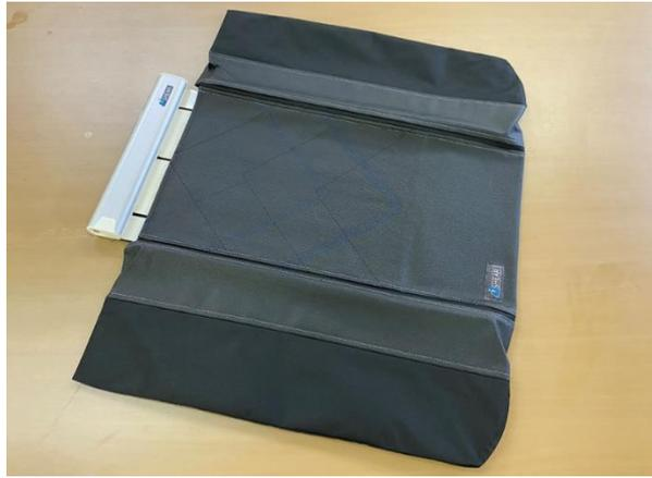
図3 ずれ力測定器 (Vicair BV 社, iShear)
