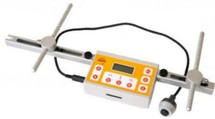
**図4 傾斜角度測定器 ホライゾン**
