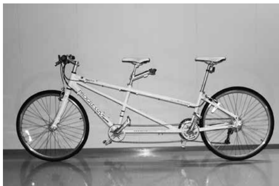
図1. タンデム自転車 (TDM-710, 重さ:16.5kg, 車輪直径:24インチ, PROGRESSIVE 社製)
