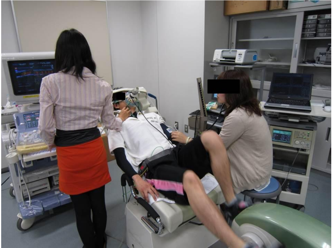
図 5.9 ストレングスエルゴメータ駆動による漸増運動負荷中の WD 計測の様子.
