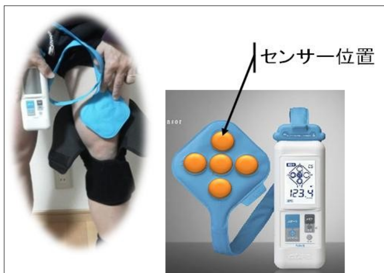
図 2. 携帯型接触圧力測定器「パーム Q」と測定位置
