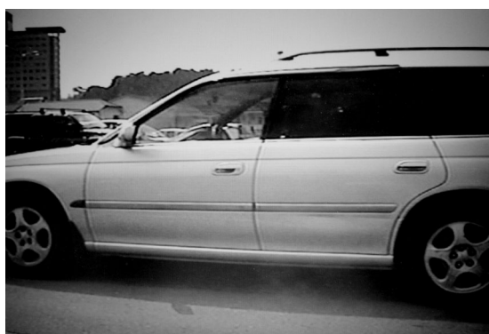
車種：ステーションワゴン(SUBARU LEGACY) 寸法：全長4670mm×全幅1695mm×全高1490mm 地面～座面550mm 地面～サイドステップ390mm
