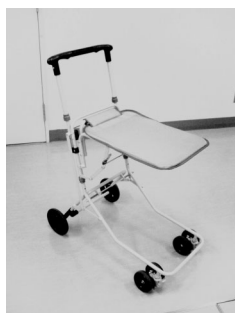
名称：試作カート(島製作所) 材質：アルミフレーム、プラスチック 重量：5.0kg 車輪：2wayダブルキャスター(前輪)、固定輪(後輪) 寸法：奥行740mm×幅410mm×高さ900~970mm(展開時) 奥行570mm×幅410mm×高さ750mm(収納時) 特徴：荷台部分に滑りやすい素材を使用し、荷物をスライドさせての移動が可能 荷台、ハンドルの高さ調節が可能
